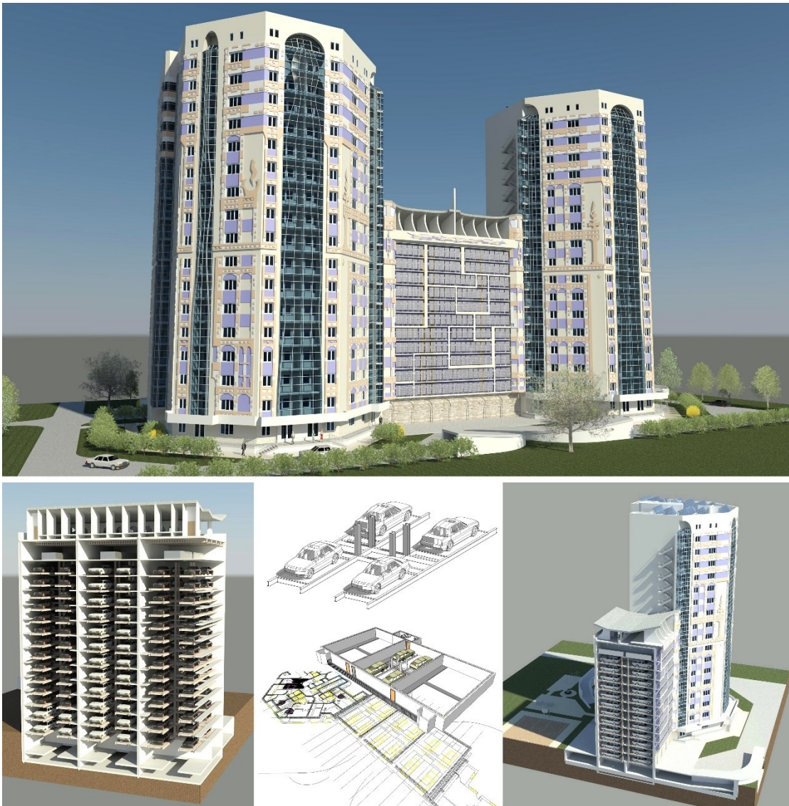
Рисунок 14. Проект многоэтажного жилого дома с многоуровневой автоматизированной парковкой. Покупатель хорошо видит по модели, за что он платит деньги. И.Козлов, 2010.
