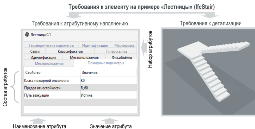
Рисунок 8. Требования к геометрии и атрибутивному наполнению элементов ЦИМ на примере «Лестницы».
