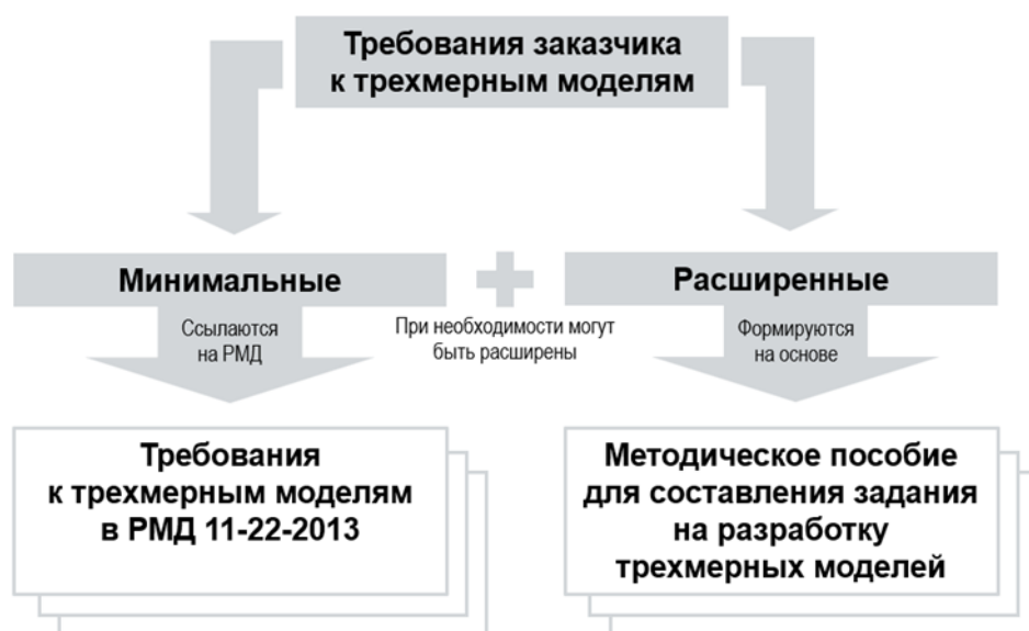
Рисунок 10. Минимальные требования заказчика к трехмерным моделям могут быть расширены с учетом потребностей в структурированной информации.
