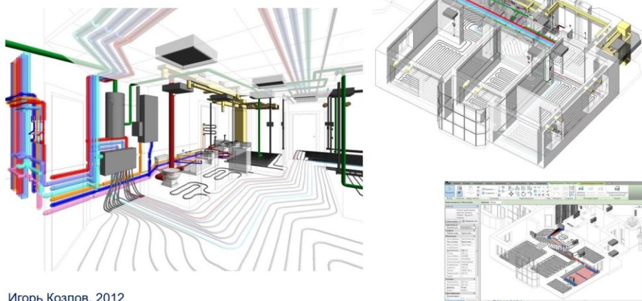
Рисунок 5. Информационная модель инженерного оборудования квартиры для решения задач управления.
