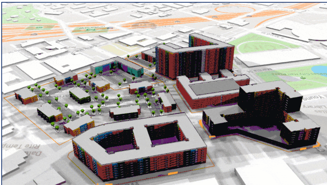
Рисунок 3. Генеративный дизайн микрорайона с 3D моделями объектов (программное обеспечение TestFit)
